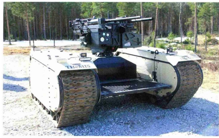
Elsel ha realizzato (ed esportato) la sua torre a controllo remoto LIVET (Light Vehicular Turret). Tale RCWS è stata testata anche sull'UGV (Unmanned Ground Vehicle) THEMIS di Milrem Robotics. (tutte le immagini sono di Elsel)
